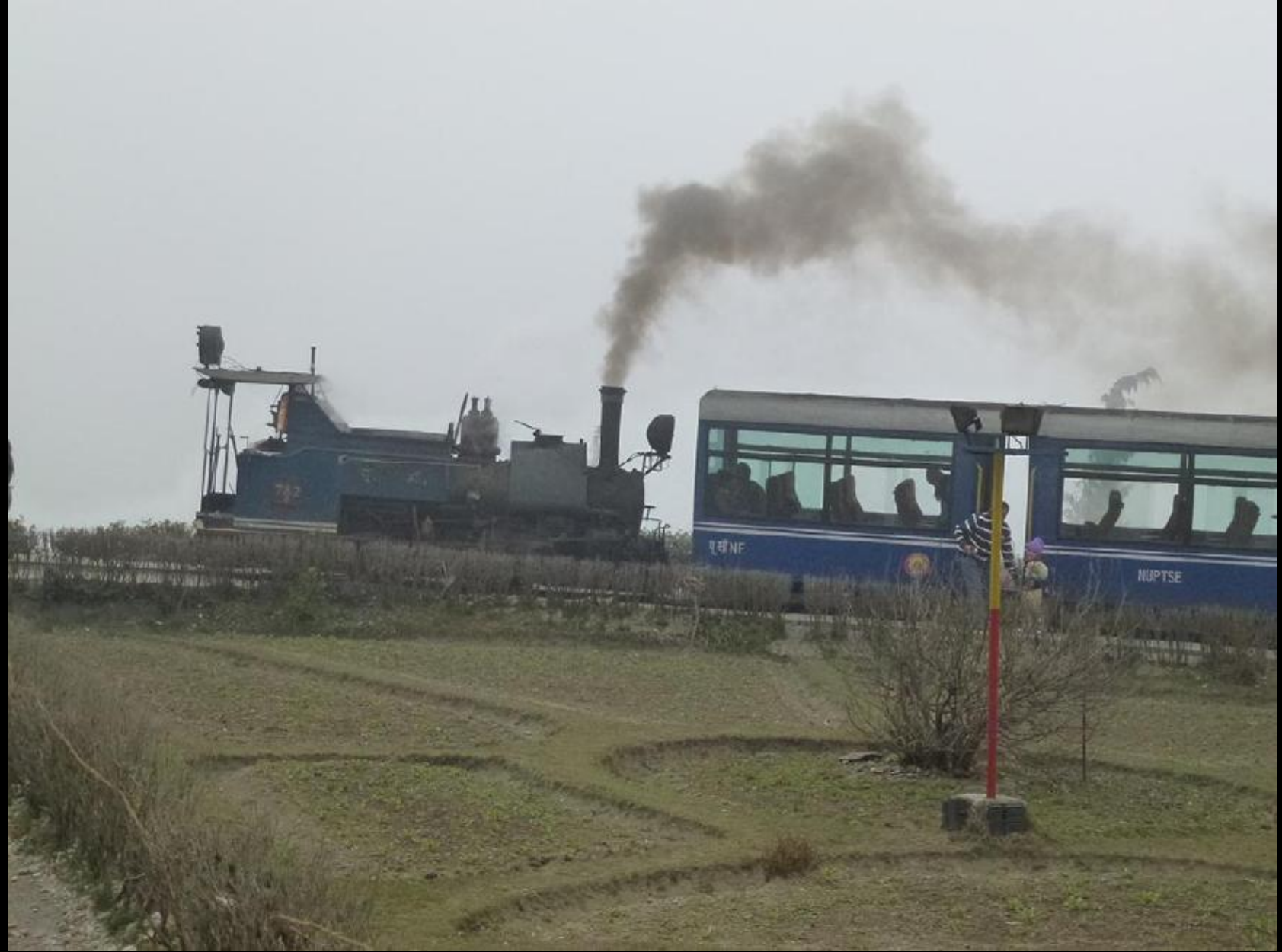
« Himalayan railway » : écartement 61 cm ! Entre Siliguri (200 m) et Darjeeling (2200 m). Terminé en 1881. Patrimoine mondial UNESCO
